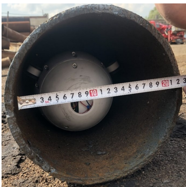
Рис. 15. Движение конструкции ВРК в УПДТ 200–500 мм
