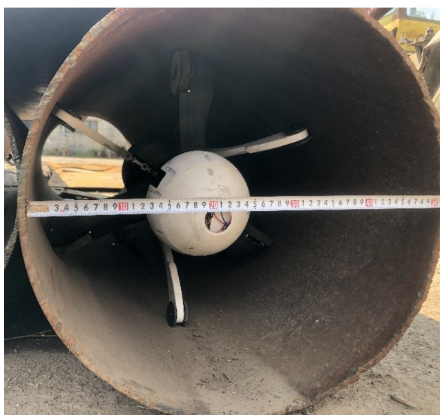
Рис. 15. Движение конструкции ВРК в УПДТ 200–500 мм
