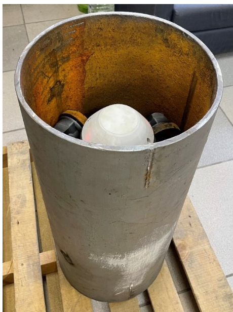
Рис. 16. Движение конструкции ВРК по вертикальному участку
