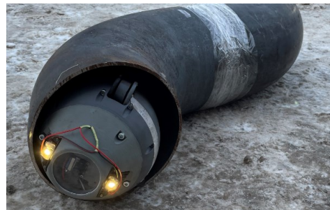
Рис. 17. Перемещение экспериментального образца ВРК на испытательном стенде
