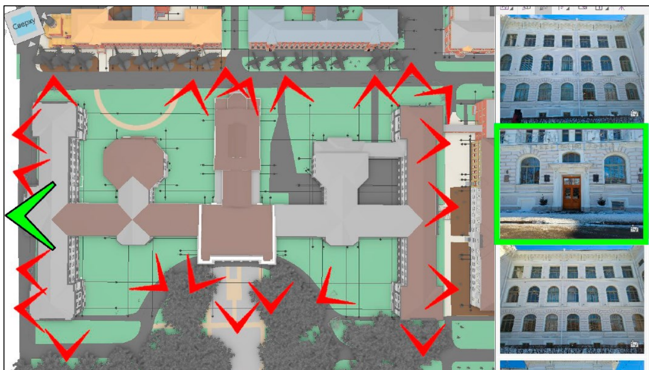
Рис. 9. Автоматическое позиционирование фотографий к модели
